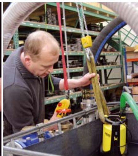
Sehr wichtig bei den Schmutzwasserpumpen: Verfügt das Gerät über einen Universalanschluß, und kann ich als Privatanutzer schnell und einfach einen Schlauch montieren? Im Praxistest (Bild rechts) stellte sich dann schnell heraus, ob der aufmontierte Schlauch und der Anschluß fest sitzen.
